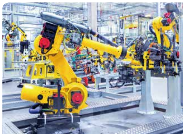
図2: ロボット同士がやり取りを行う組立ライン
