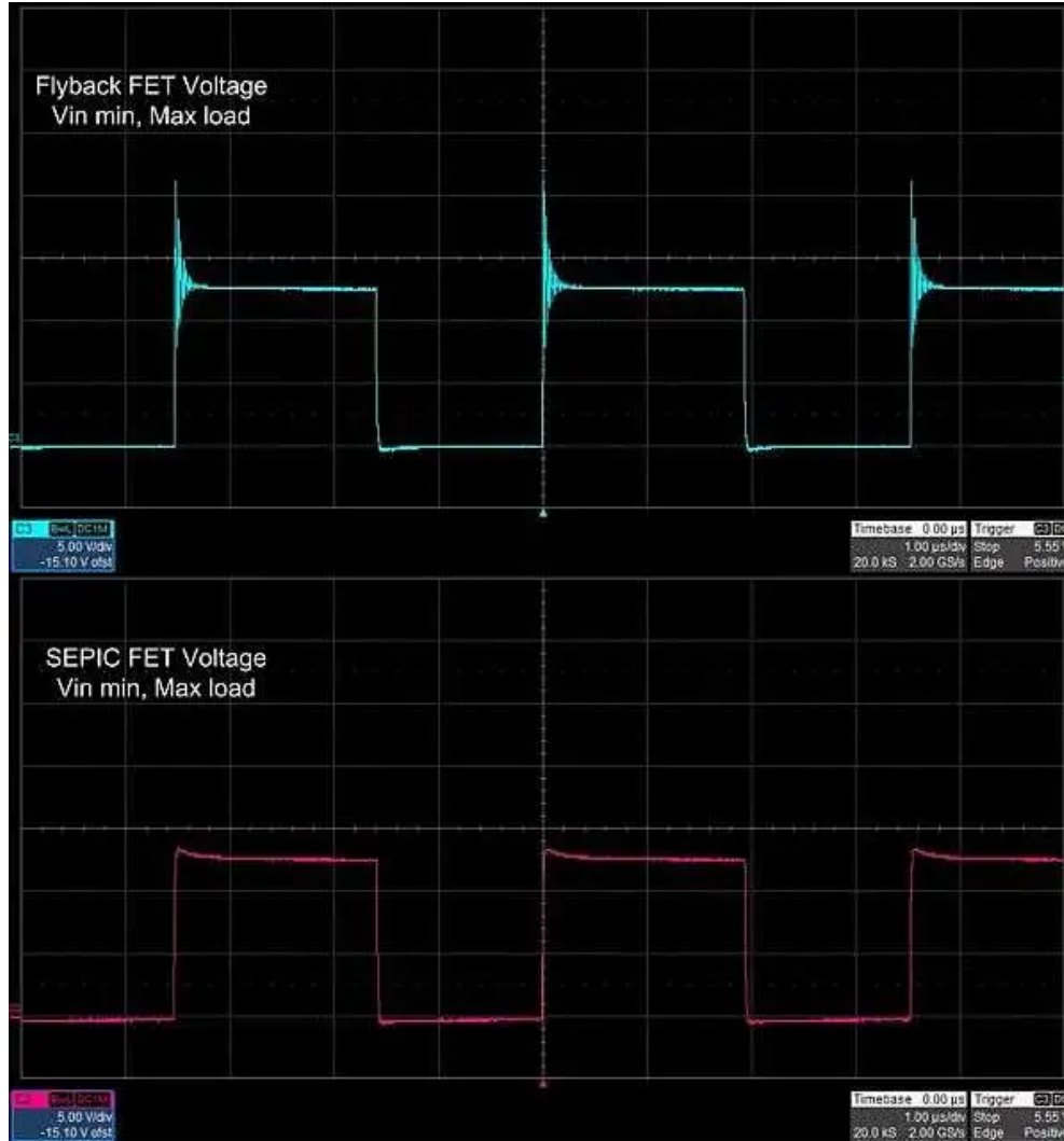
그림 2. SEPIC FET의 전압 링잉은 플라이백보다 적으므로 스트레스를 낮추고 출력 전압 조정을 개선합니다.
