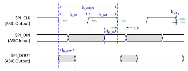
Figure 5-9. TPS99000-Q1 Interface Timing
