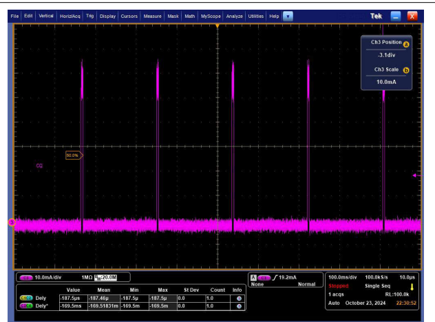
t_{SC} = 5\text{ms} t_{AR} = 200\text{ms} I_{O(LIM)} = 35\text{mA} (min)
