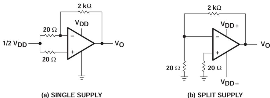
Figure 6-2. Noise-Test Circuit
