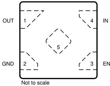
Figure 4-1. DQN Package, 4-Pin X2SON (Top View)
