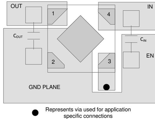
**Figure 7-6. Layout Example for the DQN Package**
