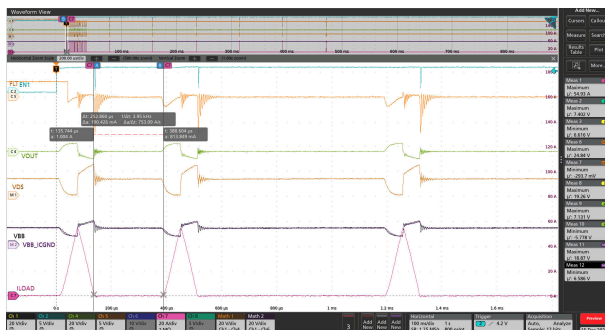
VBB = 13.5V V OUT1 = STG T AMB = 125°C I LIM = STG V EN1 = 5V
