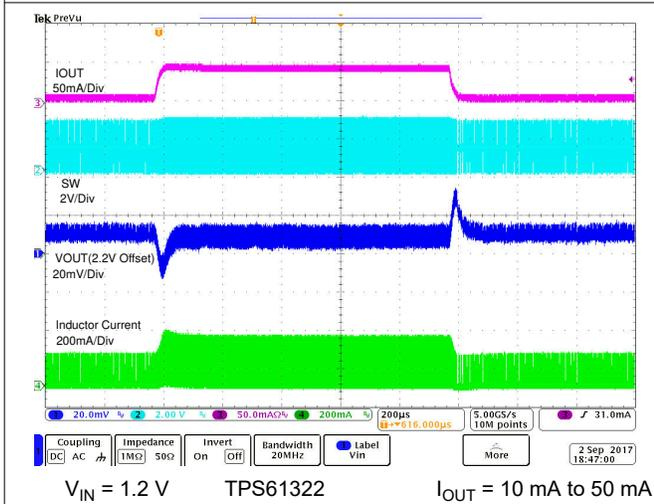
Figure 8-6. Load Transient
