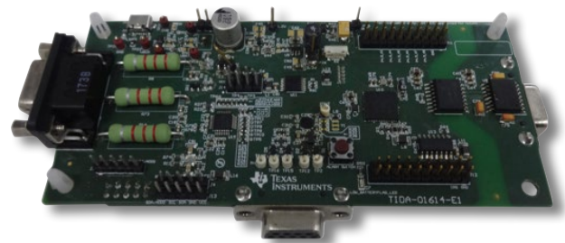
Abbildung 2. Referenzdesign für Multiparameter-Frontend.
