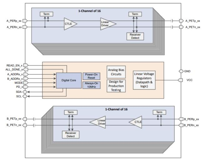
Figure 2-2. DS320PR1601 Block Diagram
